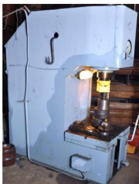
Пресс гидравлический правильно-запресовочный ус 63 т.с.
