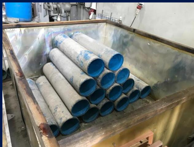
Защита трубопроводов для цемента при помощи композита CERAMET XL140 с термической закалкой. Транспортировка цемента производится при температуре около 120°C и сопровождается высокой абразивной нагрузкой.
